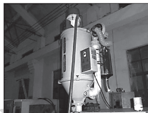
图2 改进后的热风斗式干燥机
